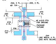
NOTES: 1.TRACE WIDTH IS SHOWN FOR ROGERS R04350B WITH DIELECTRIC THICKNESS 0.020" ± 0.0015"; COPPER: 1/2 OZ. EACH SIDE. FOR OTHER MATERIALS TRACE WIDTH MAY NEED TO BE MODIFIED. 2.BOTTOM SIDE OF THE PCB IS CONTINUOUS GROUND PLANE.
