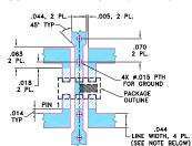
IES: 1.TRACE WIDTH IS SHOWN FOR ROGERS RO4350B WITH DIELECTRIC THICKNESS 0.020" ± 0.0015"; COPPER: 1/2 OZ. EACH SIDE. FOR OTHER MATERIALS TRACE WIDTH MAY NED TO BE MODIFIED. 10 BE MODIFIED. 2.BOTTOM SIDE OF THE PCB IS CONTINUOUS GROUND PLANE.
