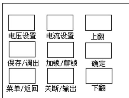
图 3.1 DH1716A 电源的按键分布图
